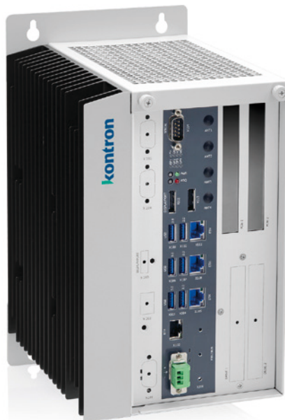
Kontron-Industrie-PCs: Speziell für den Einsatz in Schaltschränken im Automatisierungsumfeld konzipiert.
