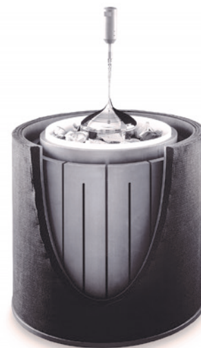
Spezialgraphite ermöglichen im Heater die Halbleiter-Kristall-Züchtung.
